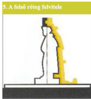
felső RTV-2 szilikon réteg felvitele
