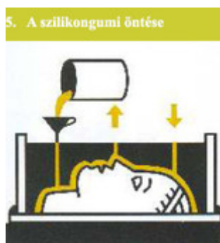
az RTV-2 szilikongumi öntése
