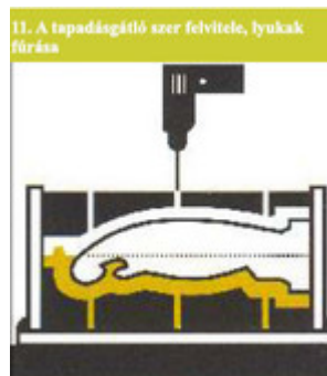
tapadástgátló szer felvitele, lyukak fúrása
