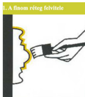
a finom szilikon réteg felvitele
