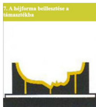
a héjforma beillesztése a támasztékba
