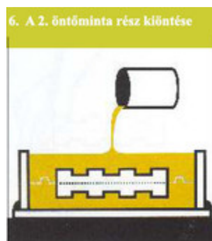
a 2. öntőminta rész kiöntése szilikonnal
