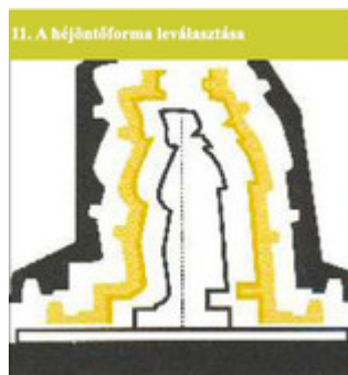
a héjöntőminta leválasztása
