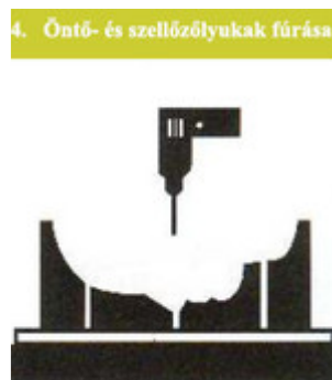
öntés szellőző nyílások fúrása
