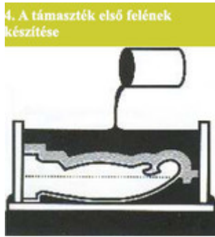
támaszték első felének készítése
