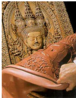
önthető szilikon leválasztása
